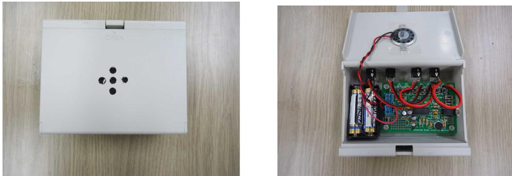
ケースにボイスレコーダーを取り付けたVOCA（携帯用会話補助装置）のようなもの。ケースのふたを開き、録音マイクに向かって録音ボタンを押し続けると、チャンネル1つで150秒まで音声録音でき、4チャンネルで約10分間の音声録音が可能となります。ケースを閉じ、外部スイッチ（棒スイッチ等）を取り付けて押し、録音された音声再生されます。
