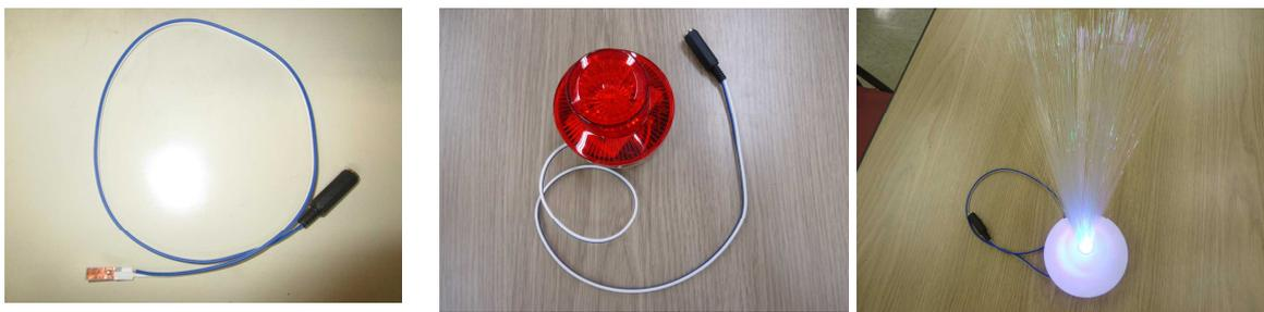
BDアダプターの先端を電池で動くおもちゃなどの電池と電池ホルダーの電極の間に入れて、外部からスイッチ操作できるもの。写真のようなLEDランプや100円ショップで販売しているおもちゃなどにBDアダプターのジャックにスイッチを接続して使います。
